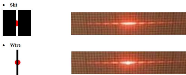
चित्र 9.3: एक रेखाछिद्र और एक तार द्वारा उत्पन्न विवर्तन पैटर्न का तीव्रता वितरण।
